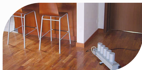
Pomiar dźwięków uderzeniowych
